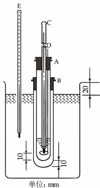
图 凝点测定仪器装置
